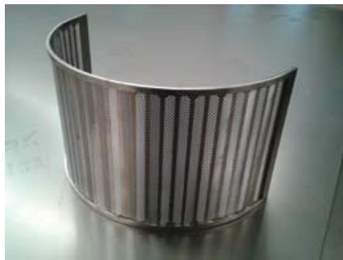
Corte láser de oblongos de 1x12 mm.
