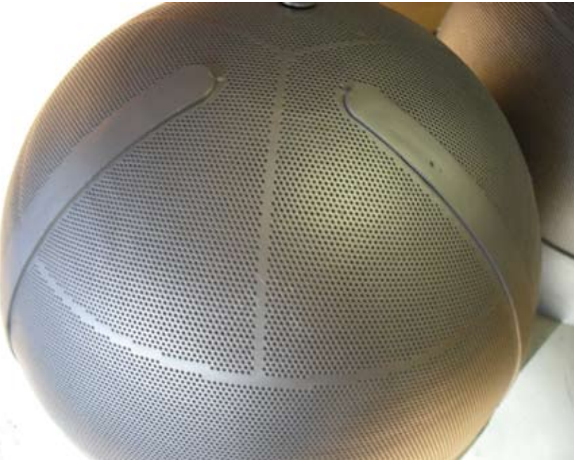
Semiesfera con áreas libres de perforación. AISI 316 Esp 1,2mm. Diam.0,7mm Entrecentro 1,5mm
