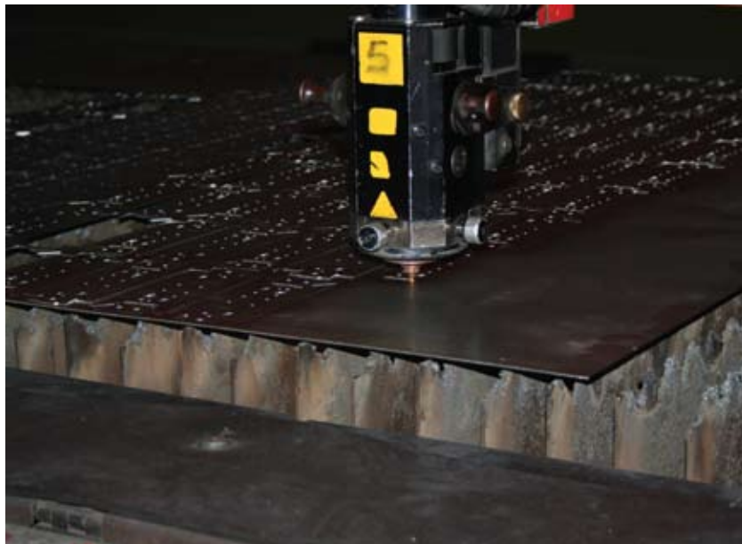
La relación espesor/diámetro es más amplia en el caso del láser.
